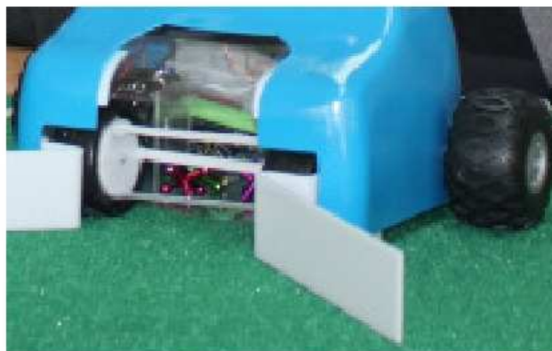
Figura 4.1.11 Prototipo final concepto 1, acercamiento mecanismo de recolección.
