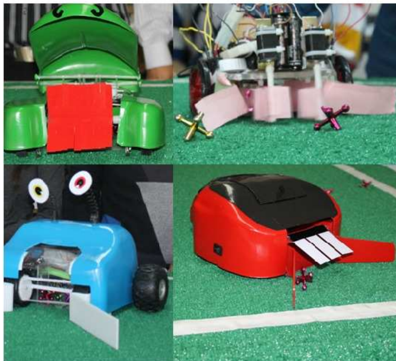
Figura 4.2.9 Vehículos que almacenan matatenas.
