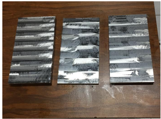
Figura R.2. Careado de placas mediante centro de maquinado Haas VF1, corte de cara B.
