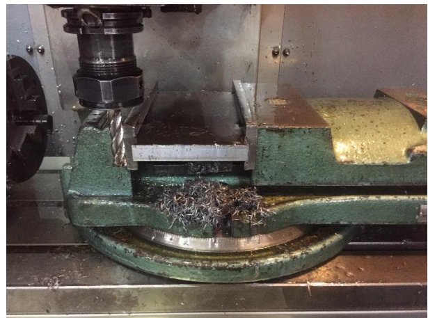
Figura R.1. Escuadrado de las placas mediante centro de maquinado EMCO VMC-300. Corte de cara C lado izquierdo, Corte de cara A lado derecho.
