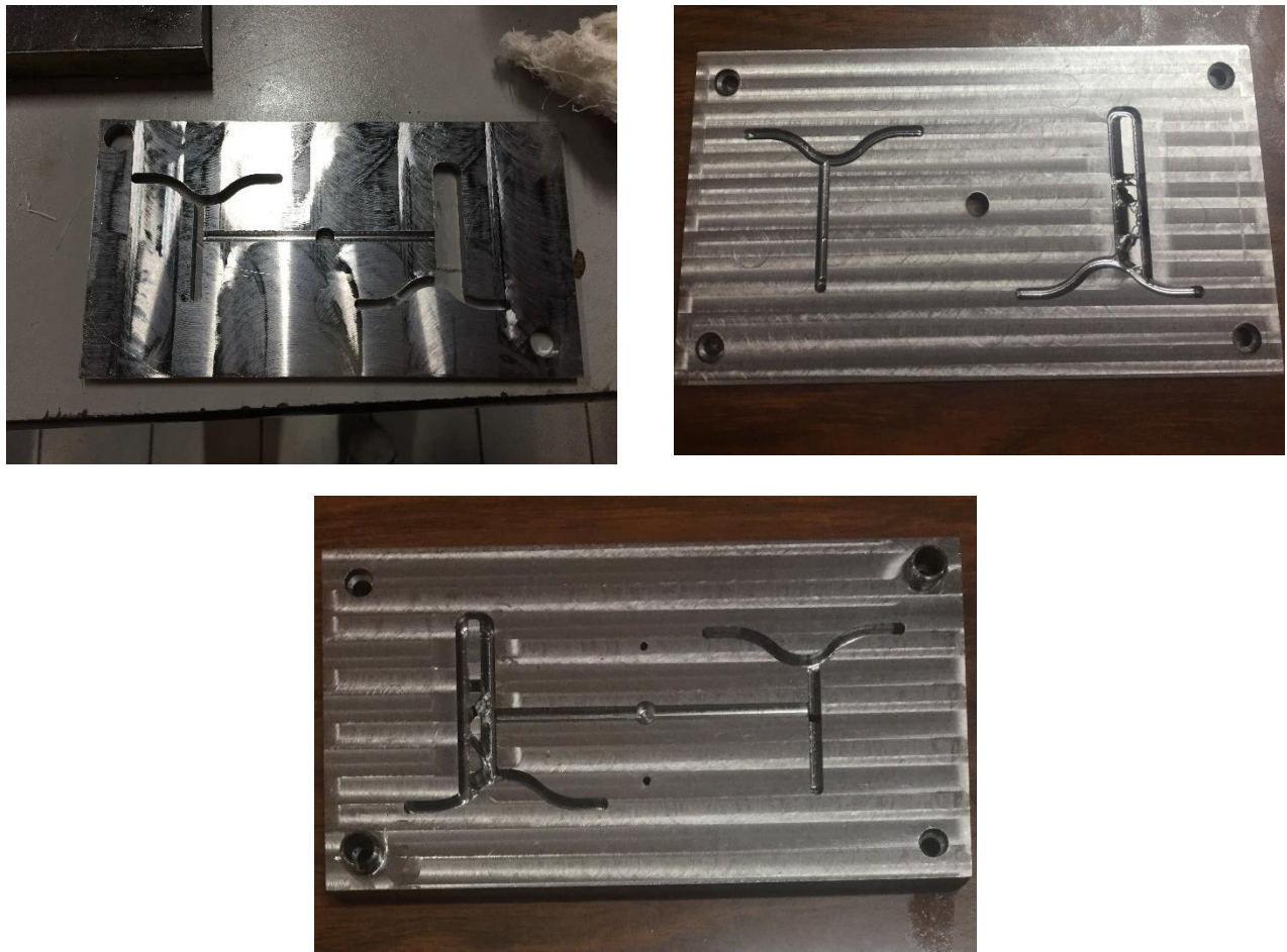
Figura R.5. Placas de cavidades del molde 1 terminadas.
