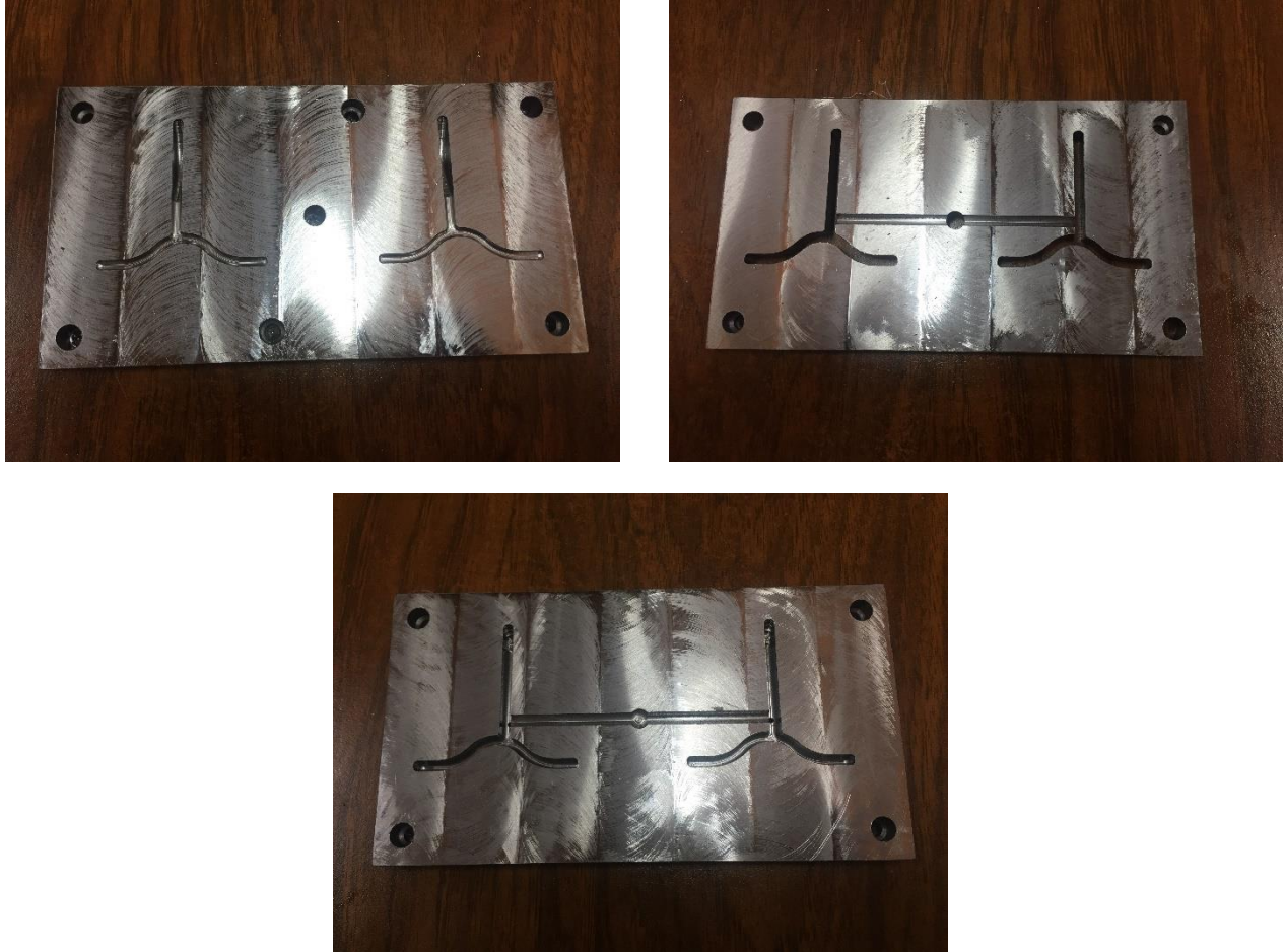
Figura R.6. Placas de cavidades del molde 2 terminadas.
