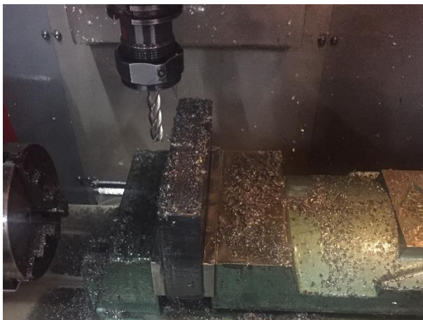
Figura R.1. Escuadrado de las placas mediante centro de maquinado EMCO VMC-300. Corte de cara C lado izquierdo, Corte de cara A lado derecho.
