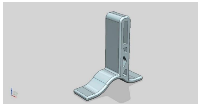
Figura 3.4. Diseño de costillas transversales para aumentar la rigidez del componente 1.
