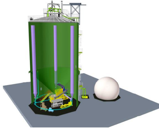
Figura 1.11 Vista de las tuberías de alimentación interna de un digester Dranco. Referencia: (De Baere, 2010).
