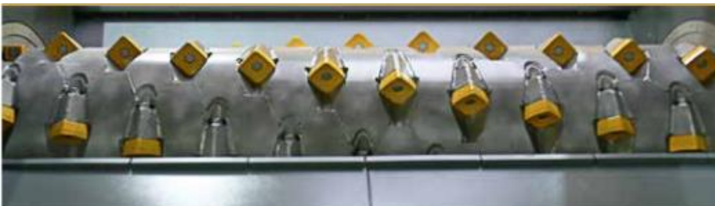
Figura 3.7 Vista acercamiento a cuchillas del rotor Referencia: (UNTHA, 2018)
