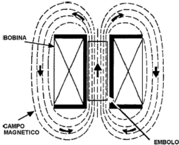
Figura 1.30. Campo producido por una bobina [22]
