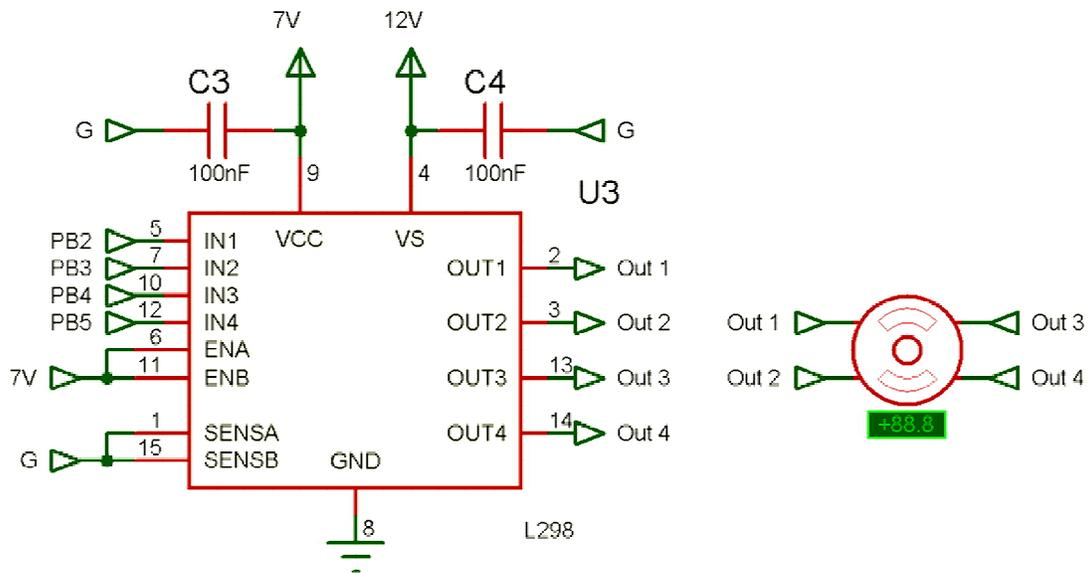
Figura 5.11. Conexiones para la fase de potencia del motor a pasos
