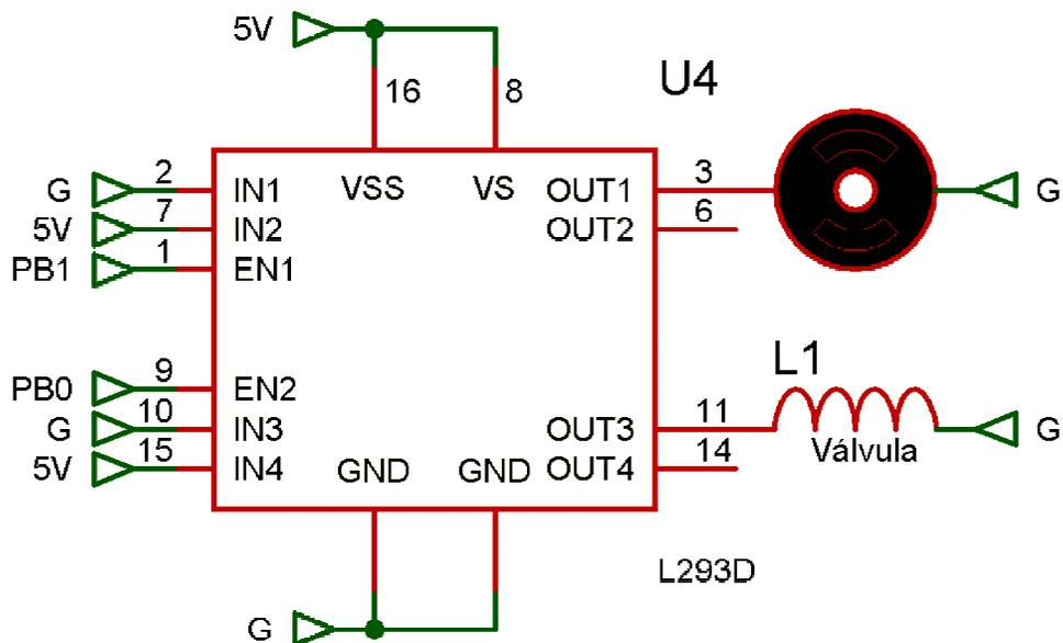
Figura 5.12. Conexiones para la fase de potencia de la bomba y la válvula
