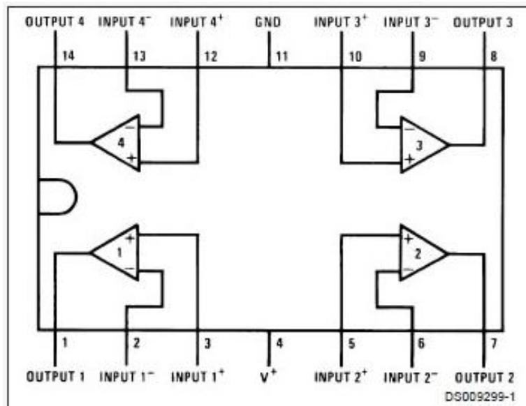
Figura 5.5. Esquema del circuito integrado LM324. Imagen tomada de las hojas de especificaciones
