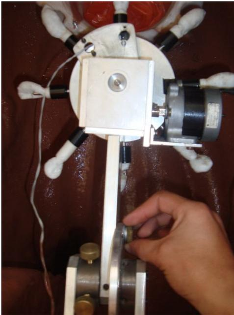
*Figura 3.11.* Brazo del mecanismo en posición vertical para pruebas en ovarios de silicón
