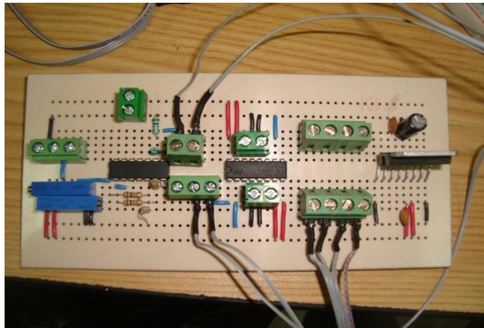
Figura 5.2. Tarjeta diseñada para el montaje del circuito electrónico
