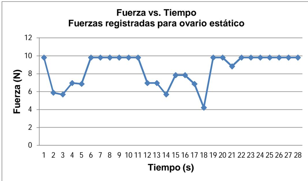
Figura 6.1. Fuerzas registradas en ovario de silicón que no presenta ninguna estructura funcional.
