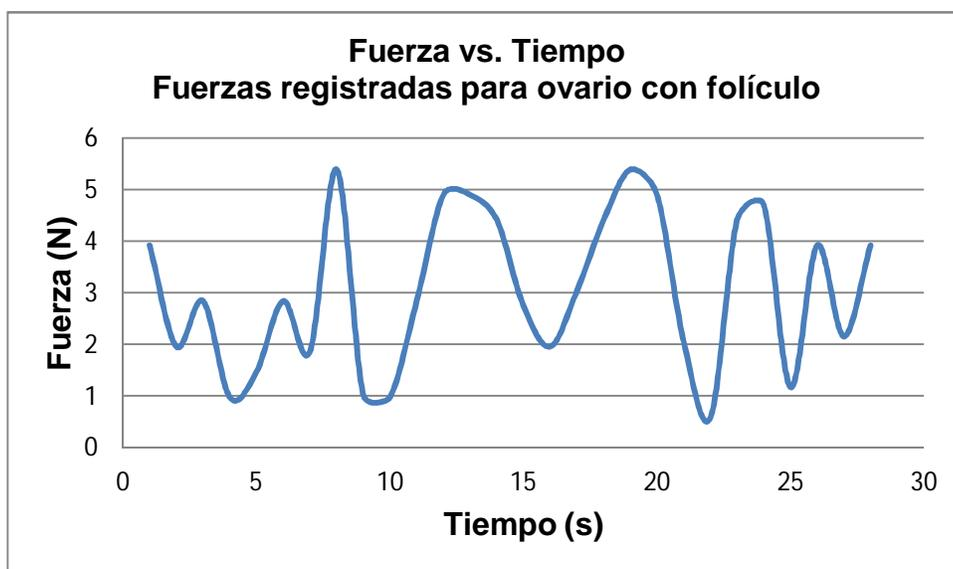
Figura 6.3. Fuerzas registradas en ovario de silicón que presenta una estructura con folículo.
