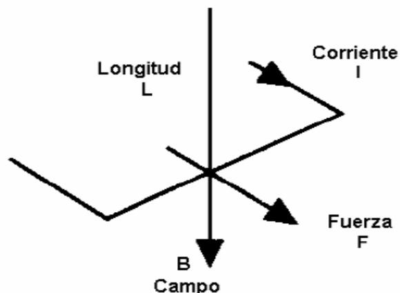
Figura 1.26. Fuerza sobre un conductor por el que pasa una corriente [14]
