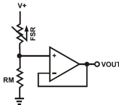
Figura 5.6. Conexión del divisor de voltaje en el FSR.
