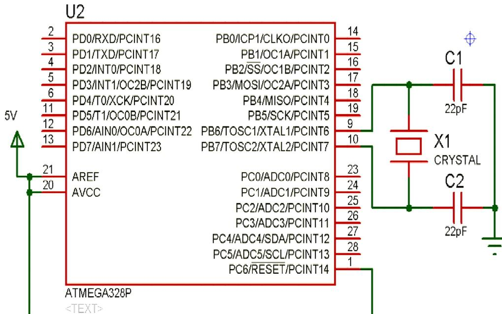
Figura 5.8. Conexiones del microcontrolador con sus elementos básicos de funcionamiento.
