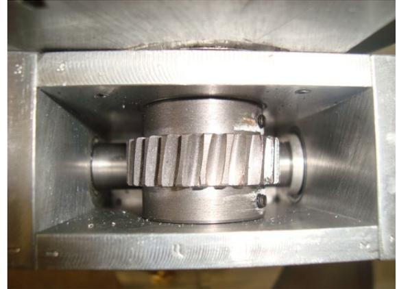
*Figura 3.8.* Vista superior del engranaje tornillo sinfín corona montado.
