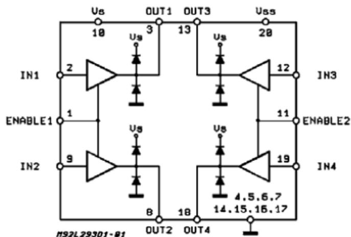
Figura 5.4. Esquema interno del circuito integrado L293. Imagen tomada de las hojas de especificaciones
