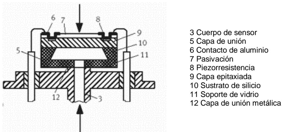
Figura 1.23. Sensor de presión piezorresistivo [17]
