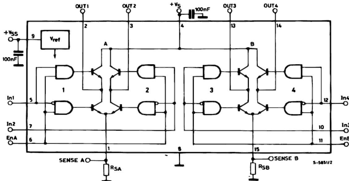
Figura 5.3. Esquema interno del circuito integrado L298. Imagen tomada de hojas de especificaciones
