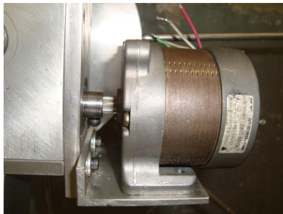
*Figura 3.9.* Motor de pasos acoplado al eje del tornillo sinfín.
