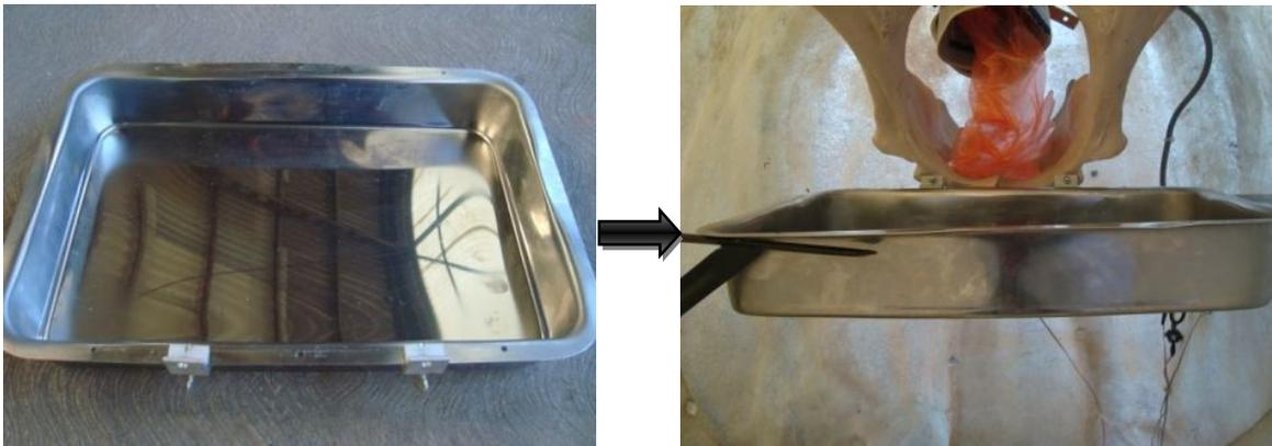
*Figura 3.6.* Colocación de la charola para pruebas en fresco
