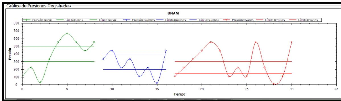
Figura 2.7. Gráficas en prueba con matrices reales. Se observan los tres niveles de presión aceptable, representados por las líneas rectas
