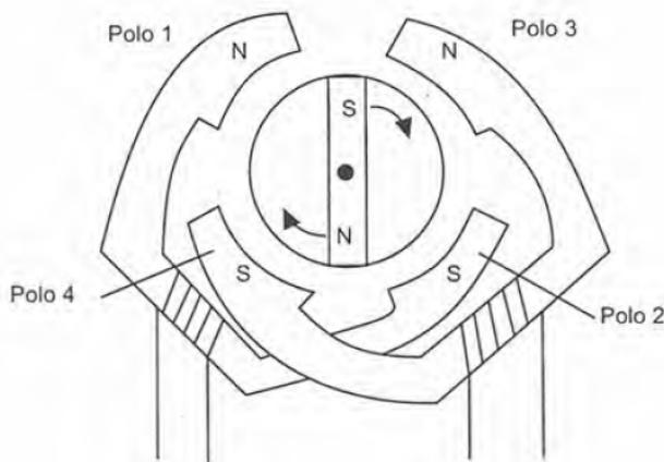
Figura 1.29. Motor de pasos de imán permanente [14]
