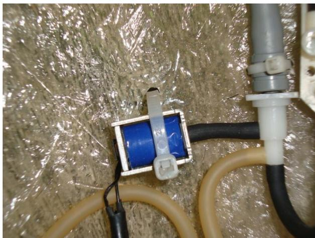
Figura 4.3. Válvula solenoide ubicada dentro del modelo bovino de fibra de vidrio
