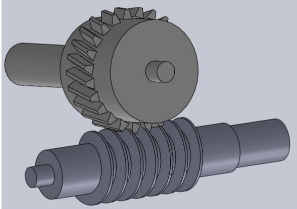
*Figura 3.7.* Dibujo del engranaje tornillo sinfín corona utilizado en el mecanismo
