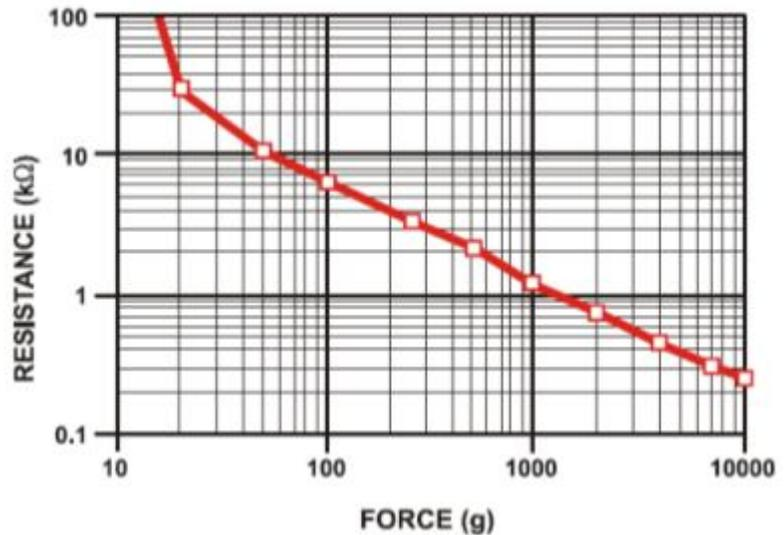
Figura 1.25. Relación entre Fuerza y Resistencia en un FSR [19]
