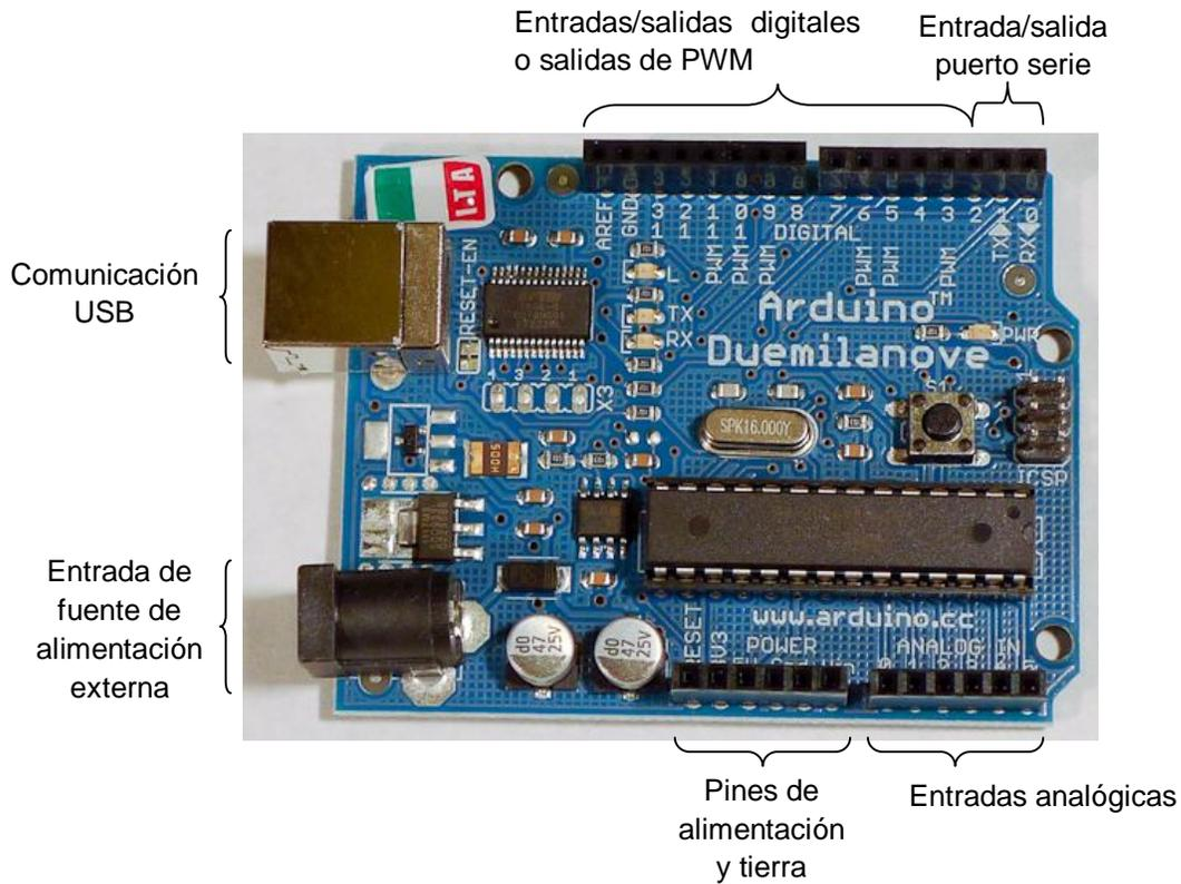
Figura 5.1. Descripción de componentes de la placa Arduino Duemilanove®
