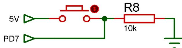
Figura 5.13. Conexiones del sensor de posición inicial hacia entrada digital del microcontrolador
