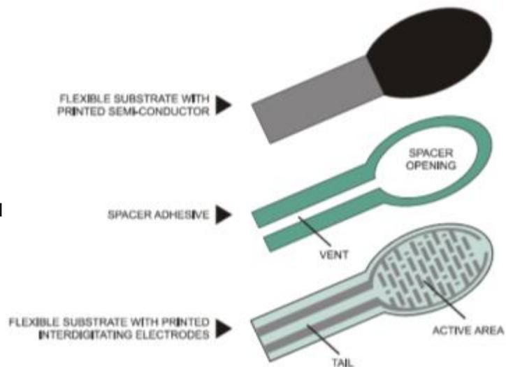
La gama usable de la señal de salida de un FSR es casi lineal. Si se aplica bastante fuerza, su respuesta se convierte en no lineal debido a la saturación del sensor, siendo la presión de saturación de un FSR típico del orden de 100 a 200 [psi]. Tiene una baja exactitud, con errores de hasta un 25% de salida [20].
