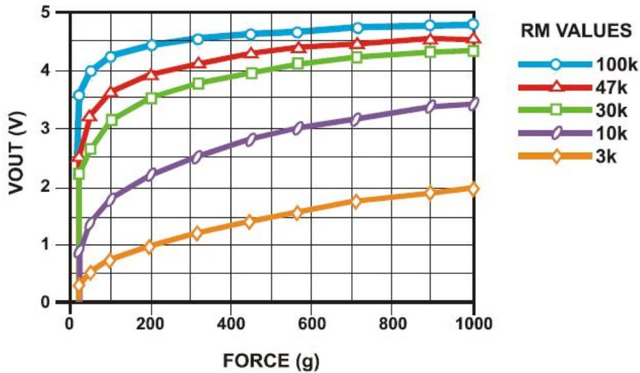
Figura 5.7. Familia de curvas F vs. V para una FSR 402. Imagen tomada de las hojas de especificaciones
