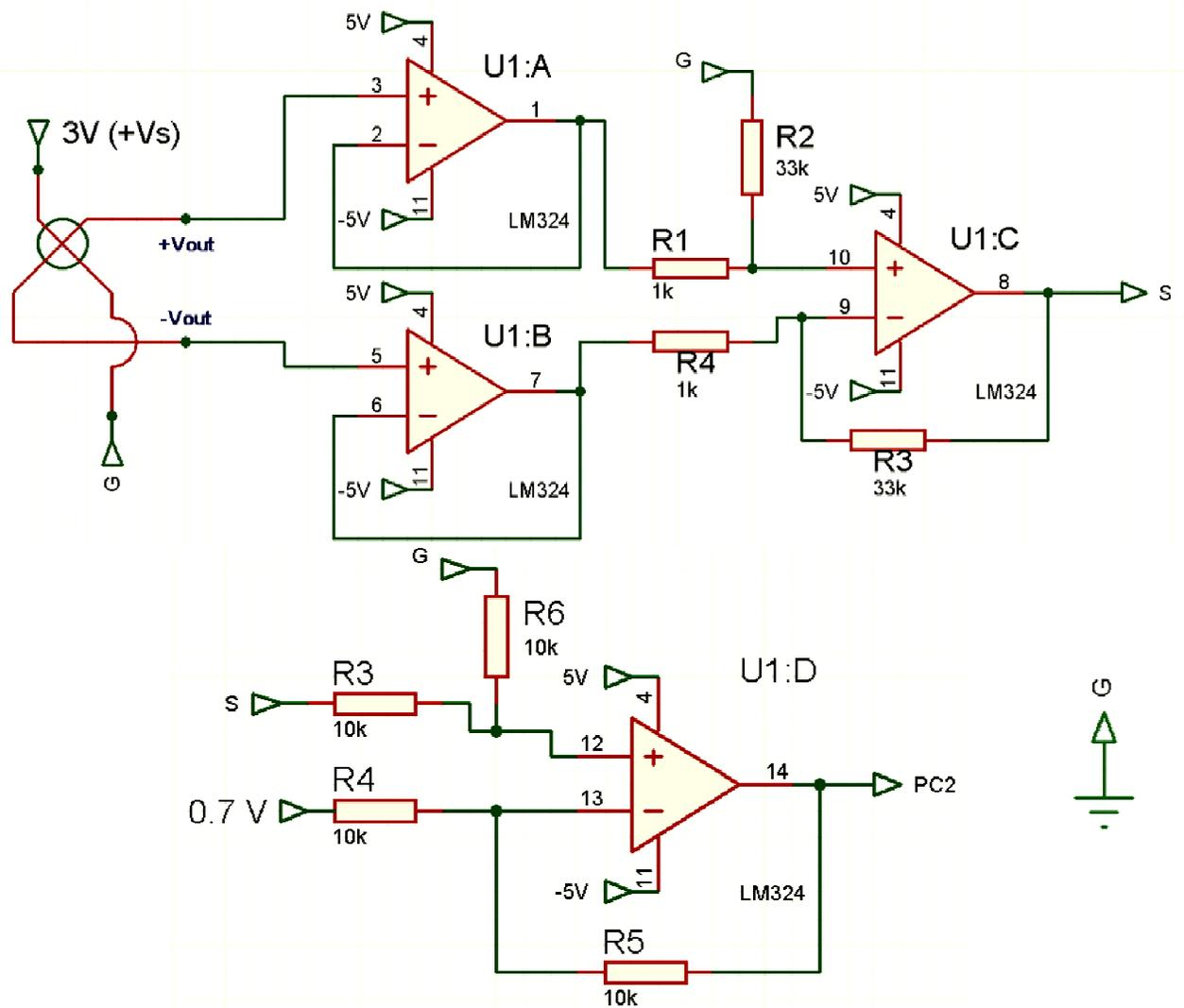
Figura 5.9. Conexiones de la señal de salida del sensor MPX10DP a la entrada analógica PC2 del microcontrolador
