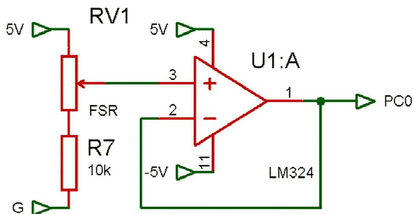
Figura 5.10. Conexiones de la señal de salida del sensor FSR a la entrada analógica PC0 del microcontrolador
