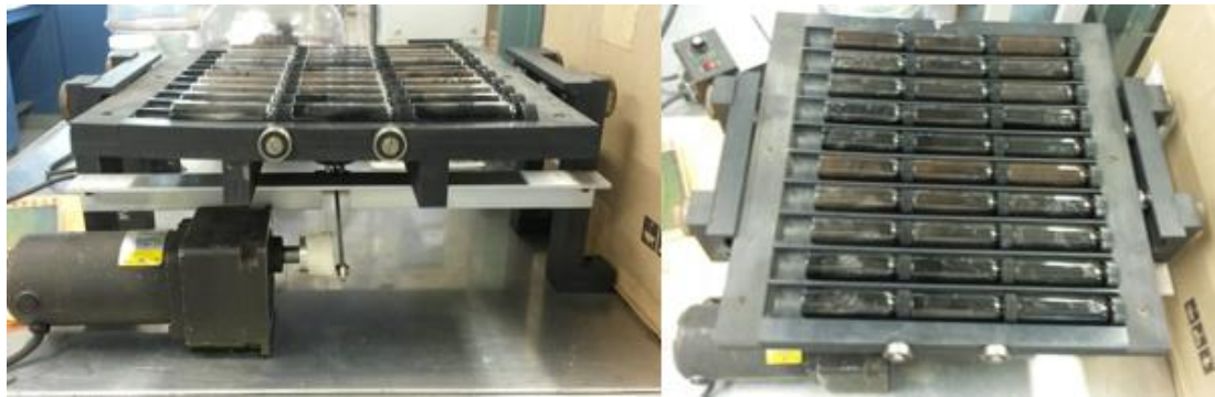
Figura 3.10 Cama agitadora con capacidad para 30 viales de 40 ml
