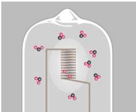
Figura 3.1.8. Las partituras de tungsteno permanecen en el filamento y las de halógeno fluyen nuevamente en libertad.
