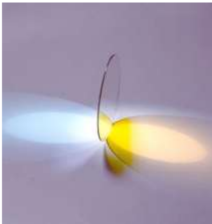
Figura 3.1.11. Filtro dicróico (de interferencia). Izquierda luz a filtrar, derecha, longitud de onda deseada.
