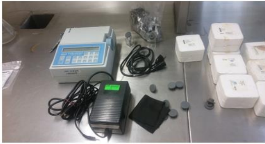
Figura II.18. Material de laboratorio para la determinación de nitritos y nitratos. LISA. 13/02/18
