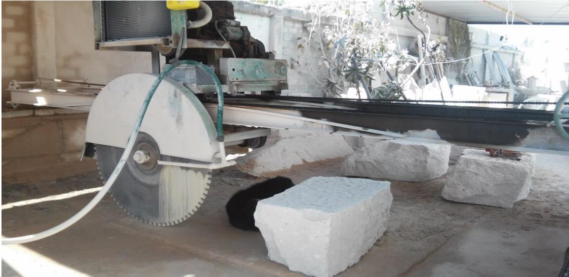
Fotografía. 4. Maquinaria para el corte de cantera. LCB 2018, fotografía propia.
