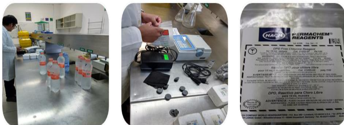
Figura II.16. Material de laboratorio para la determinación de cloro libre. LISA. 12/02/18
