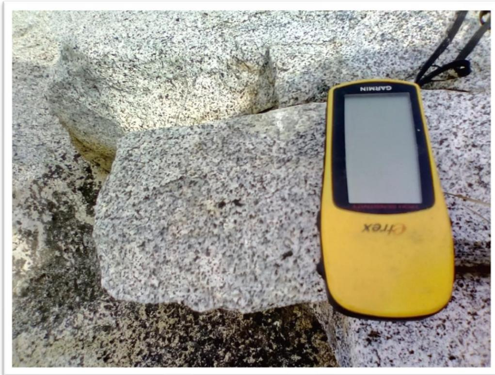
**Figura 5.1. Textura fanerítica del granito-granodiorita.**
