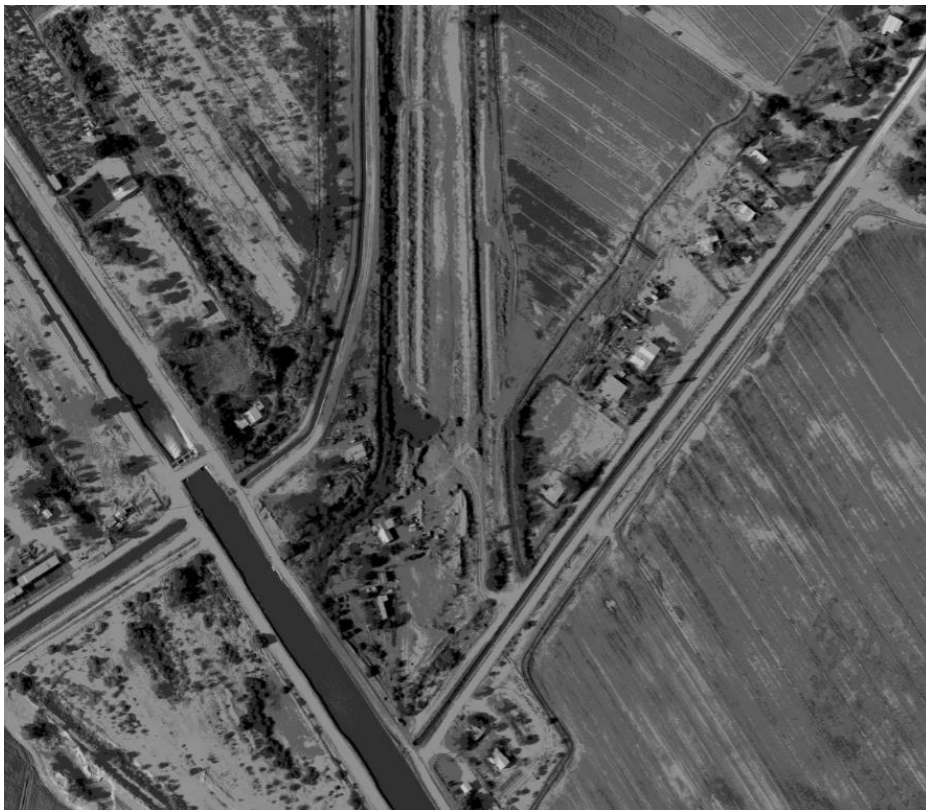
Figura 34. Ejemplo de una Imagen en escala de grises obtenida mediante Drone con una resolución de 3cm/PX
