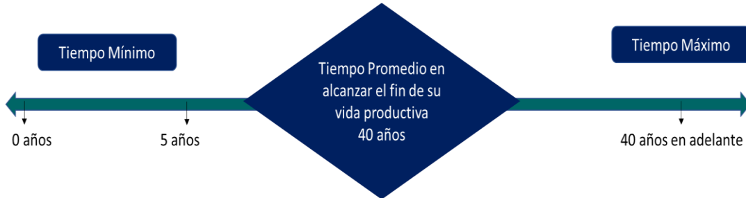
Gráfico 23 - Tiempo que tarda en alcanzar el fin de la vida productiva de un campo en aguas profundas
