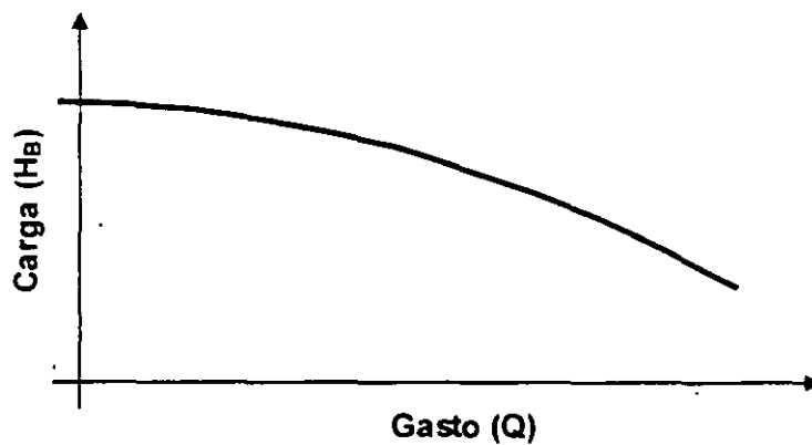
Fig. 2.4 Curva característica (carga-gasto) de una bomba
