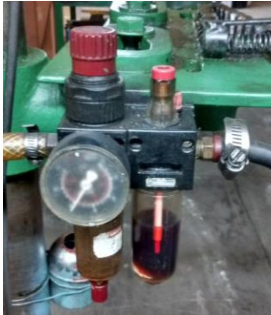
Figura 35. Unidad de mantenimiento, área de armado de quemadores. Fotografía de la planta.
