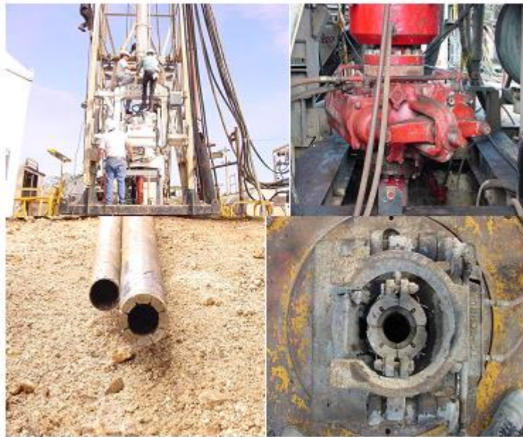
Figura 4.12 Equipo superficial rotatorio y barrena tipo corona usados en la perforación del pozo Yaxcopoil-1
