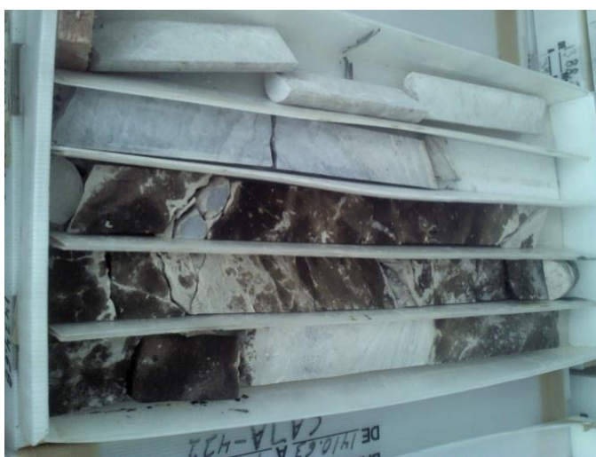
Figura 5.1 Fragmentos de núcleo ordenados dentro de los canales de la caja
