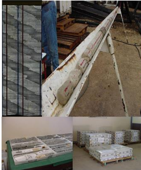
Figura 4.13 Recuperación y marcado y resguardo del núcleo del pozo Yaxcopoil-1
