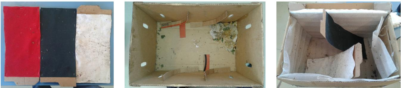
Figura 6.24: a) Rampas cubiertas con textiles. b) Interior de almacenador con guías laterales para rampas. c) Modelo ensamblado.
