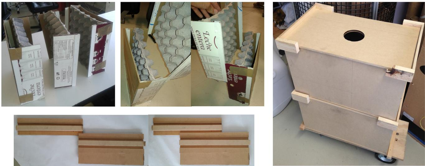
Figura 6.31: a) Bastidores separados. b) Proceso de ensamble entre bastidores. c) Vista a detalle de ensamble en iteración con mdf. d) Vista de contenedores apilables con abertura en tapa superior para ensamble con vasos recolectores.
