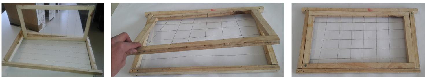
a b c Figura 6.27: a) Base inferior del bastidor interno dentro del externo. b) Proceso de cierre a presión entre bastidores. c) Ensamble final.
