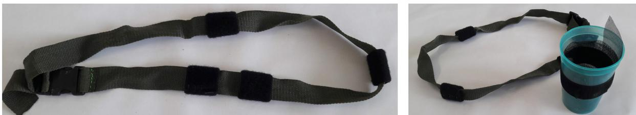
Figura 6.26: a) Cinturón con secciones para adherir los vasos recolectores. b) Modelo ensamblado.
