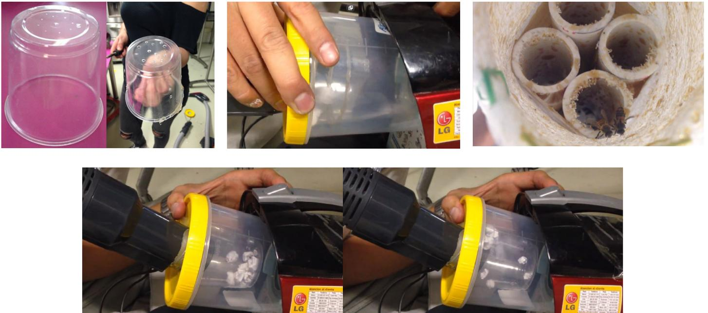
Figura A.3: a) Vista isométrica de vaso de HDPE con perforaciones en su base (izquierda) y en su contorno (derecha). b) Contenedor rígido despegado durante prueba 1. b) Desprendimiento con escape de bolitas de papel durante prueba 2. c) Aumento en recolección de bolitas (izquierda) y eventual desprendimiento de contenedor (derecha).
