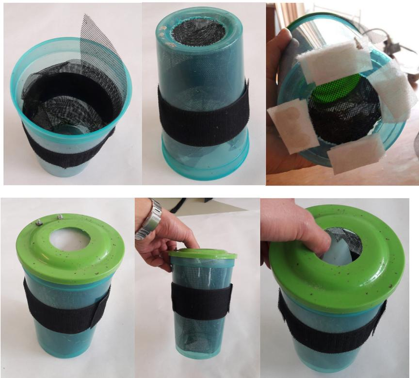
**a** **b** Figura A.8: a) Vistas superior (izquierda) e inferior (centro y derecha) sin tapa de la configuración final para el recolector de abejas con el vaso 2. b) Vista del simulador ensamblado con tapa retractil en estado de reposo (izquierda) y con carga en resorte torsional (centro y derecha).
