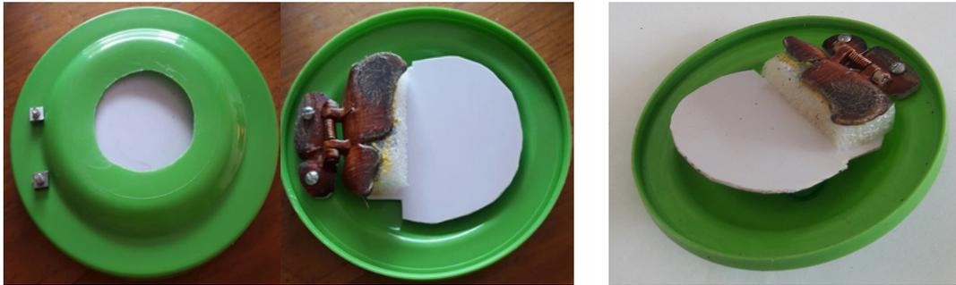
**a** **b** Figura A.7: a) Vista superior (izquierda) e inferior (derecha) de tapa retractil construida para vaso 2. b) Eventualmente el uso constante de la tapa para el ensamble con las boquillas causó un debilitamiento en el resorte torsional, lo que no permitió un cierre seguro.
