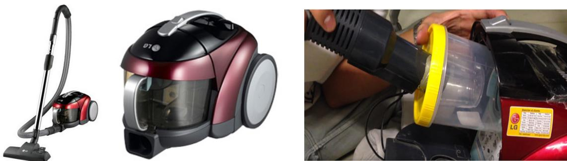
a b Figura A.1: a) Aspiradora LG ensamblada (izquierda) y carcasa del motor con recipiente guardapolvo ensamblado (derecha). b) Vaso 1 adaptado a boquilla y filtro de aspiradora de piso.
