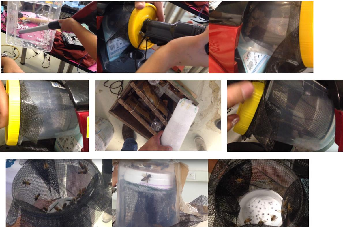
Figura A.5: a) Recolección de bolitas dentro de contenedor con boquilla de aspiradora (izquierda), manguera con adaptaciones para funcionamiento con simuladores (centro) y acumulación de bolitas al fondo del primer vaso mosquitero. b) Vista exterior del contenedor durante prueba 2 con bolitas de papel. c) Aumento en recolección debido a perforaciones en el fondo del contenedor. d) Abeja muerta atrapada en unión de vaso de unisel con malla. e) Resultados obtenidos en prueba final
