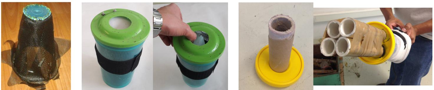
Figura 6.25: a) Vista isométrica de malla interna amortiguadora con base rígida. b) Vaso recolector con tapa en estado normalmente cerrado (izquierda) y abierto (derecha). c) Boquillas construidas: recta (izquierda) y múltiple (derecha).
