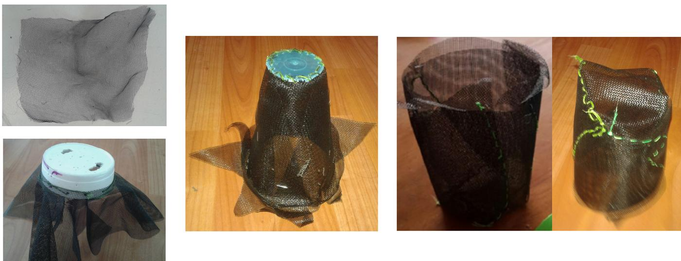
Figura A.4: a) Porción de malla mosquitera plástica utilizada para prueba inicial con éste material. b) Vista isométrica inferior de malla cosida a fondo de vaso de unicel. c) Primer alternativa final para contenedor interno. d) Vista superior e inferior de segunda alternativa final para contenedor interno
