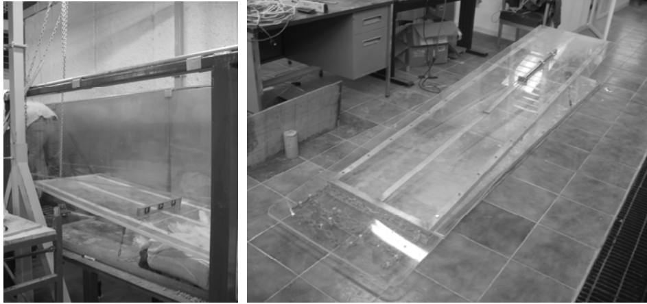
Fig. 4.2. Rampa empleada para simular la playa.
