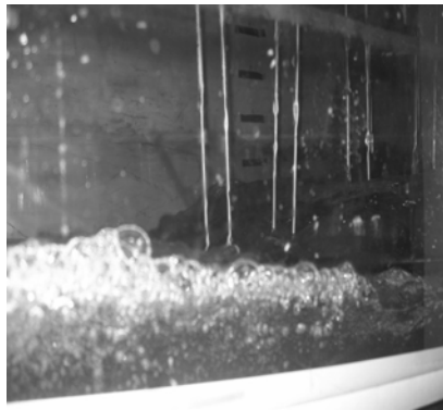
Fig. 4.4. Turbulencia en zona de rotura.
