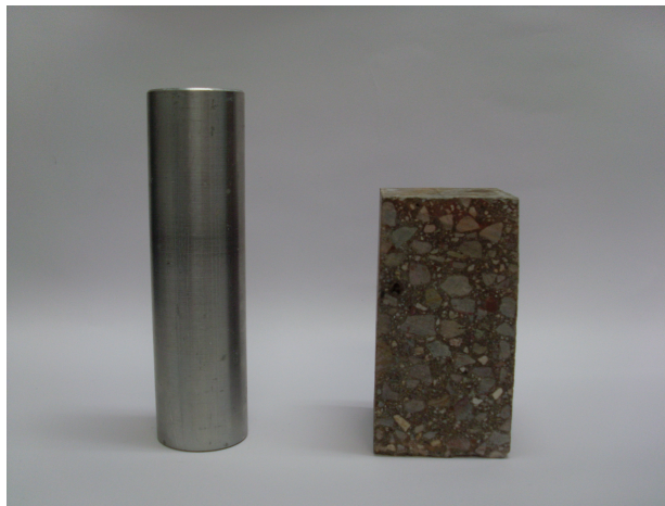
Figura 5.14: Fotografía de las probetas utilizadas en la inspección de tomografía ultrasónica. A la izquierda se muestra la probeta cilíndrica de Aluminio, mientras que a la derecha la probeta cúbica de Concreto.
