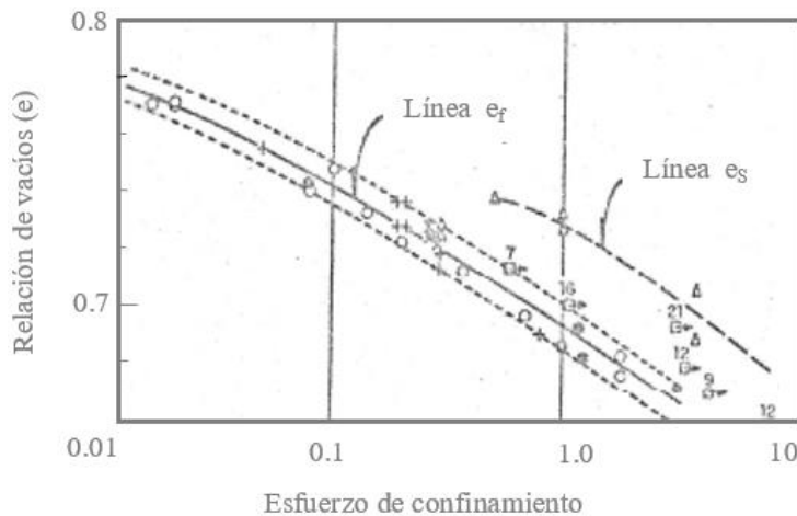
Figura 4.12 Relación de vacíos crítica obtenida mediante pruebas CD ( e_s ) y relación de vacíos crítica obtenida mediante pruebas CU ( e_f ) (Castro, 1969)
