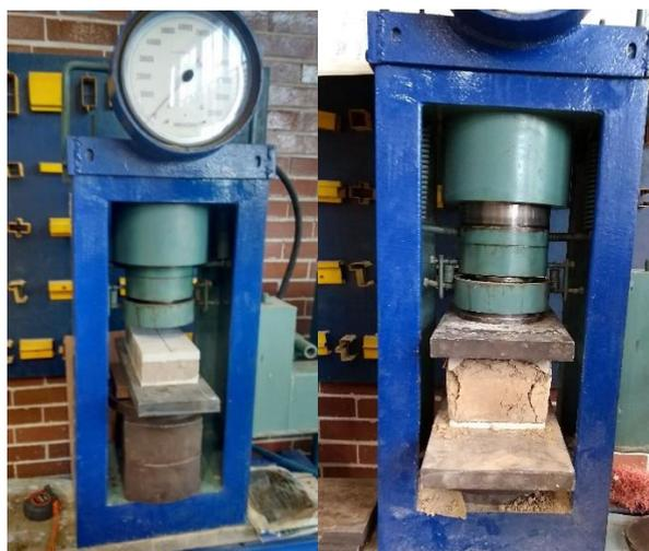
Figura 4.19. Prueba de resistencia a la compresión
