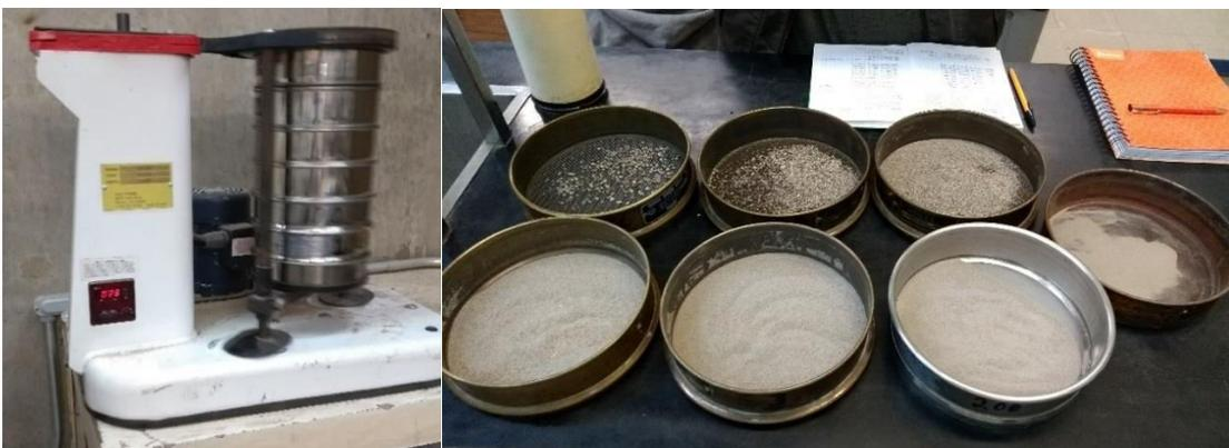
Figura 3.3. Análisis granulométrico por tamizado
