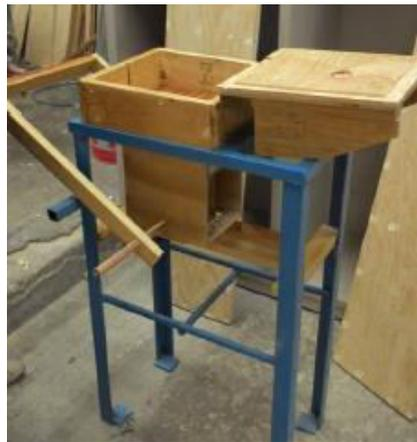
Figura 2.4. Moldeadora de ladrillos.
