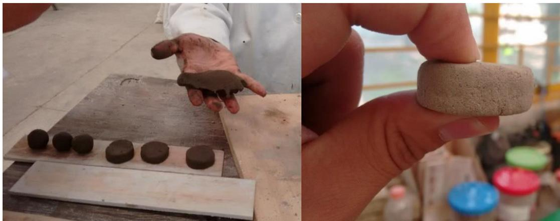
Figura 4.7. Prueba de dureza en campo
