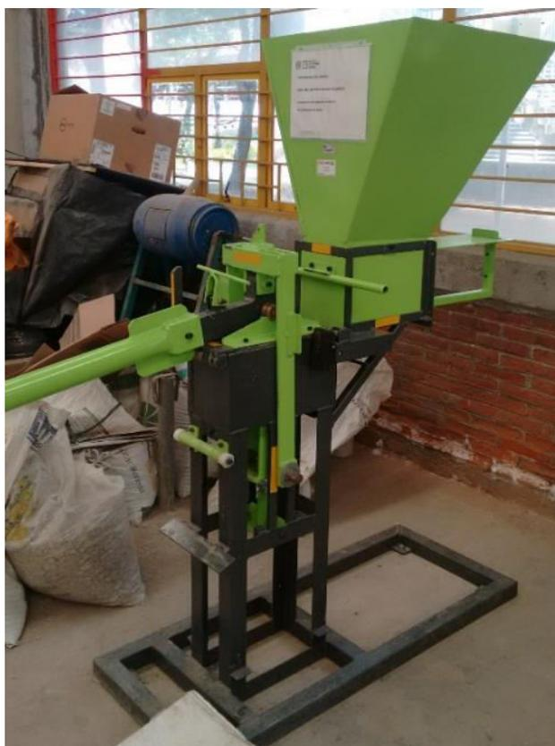
Figura 3.10. Moldeadora para bloques
