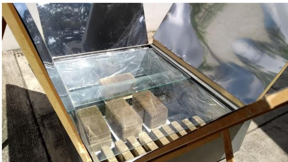
Figura 3.11. Secador solar de bloques
