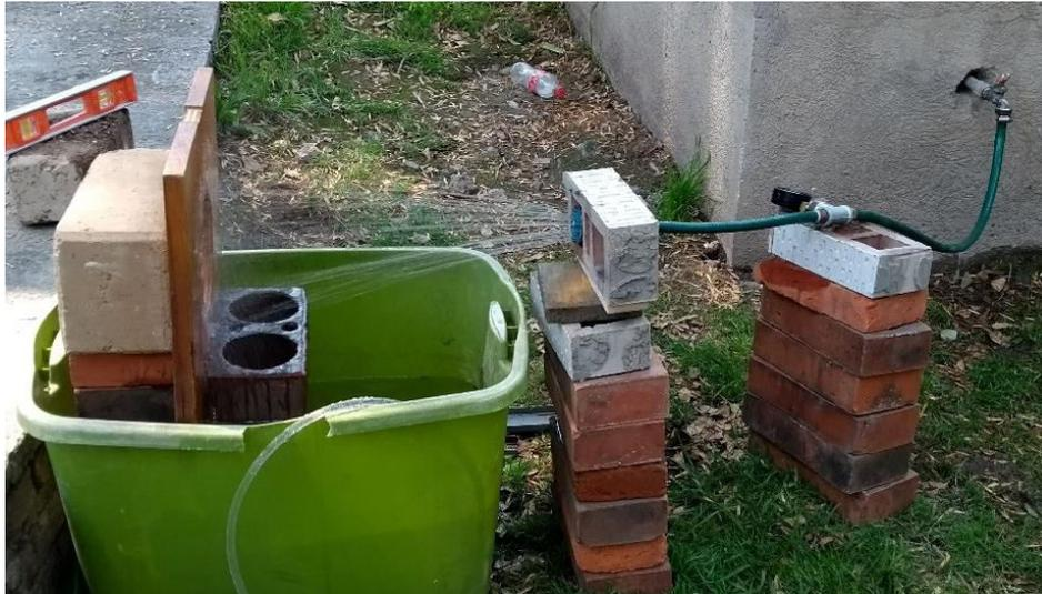
Figura 3.13. Prueba de resistencia a la erosión
