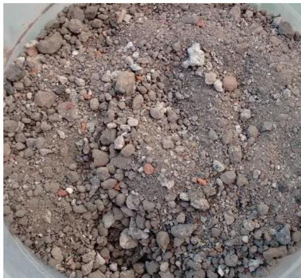
Figura 4.2. Residuos de construcción 1/4" a finos todo en uno
