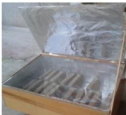
Figura 2.5. Secador solar para ladrillos
