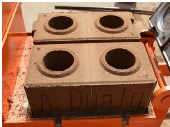
Figura 2.2. Bloque de tierra comprimido
