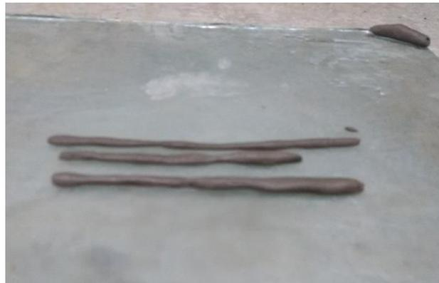
Figura 4.11. Límite plástico del material de excavación
