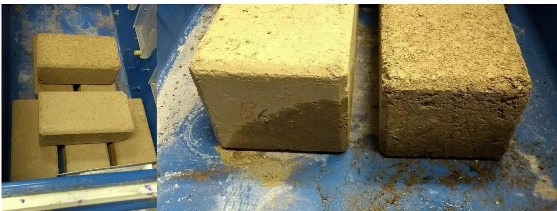
Figura 4.31. Recobloques durante la prueba de intemperismo
