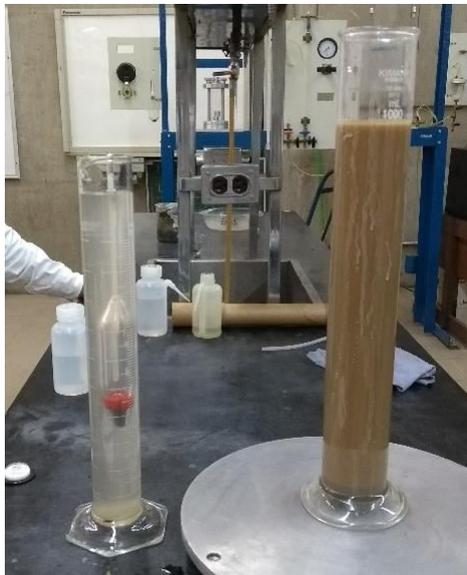
Figura 3.4. Análisis granulométrico por hidrómetro
