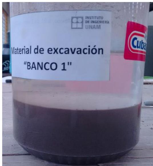
Figura 4.5 Prueba granulométrica en campo
