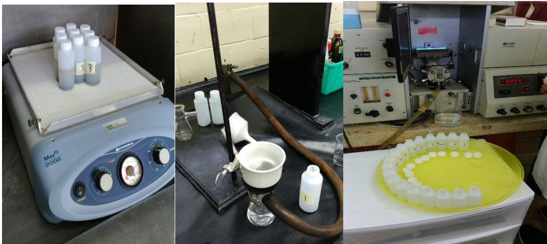
3.7. a) Agitación, b) filtrado y c) determinación de Pb con equipo de AA.
