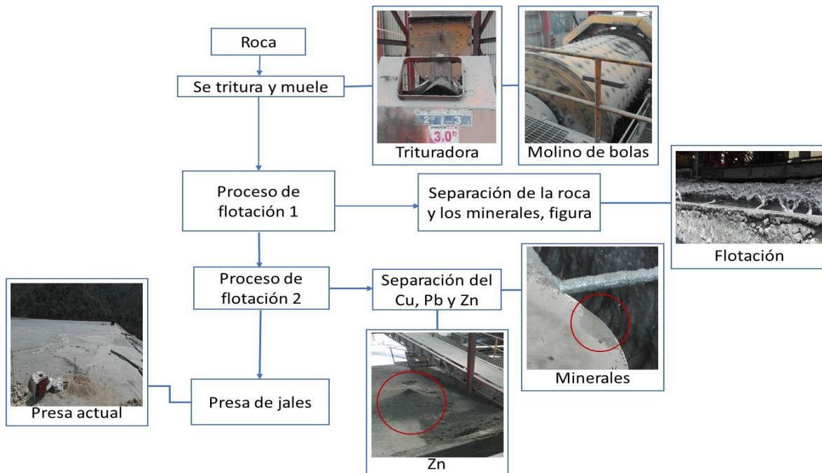
Figura 3.7. Proceso de beneficio de la mina de Zimapán, Hidalgo.
