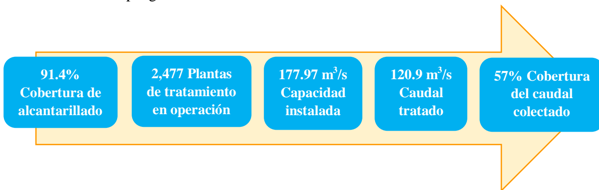
Figura 1-2. Infraestructura de saneamiento de agua residual municipal en México, 2015.
