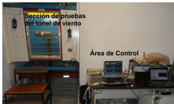
Figura 3.20: Área de trabajo para las pruebas en el túnel de viento.
