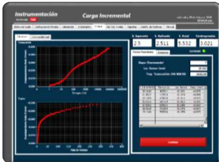
Figura B.14 Etapa 7 de consolidación (descarga) Esfuerzo efectivo de 2.5kg/cm 2 . Curva de consolidación de Casagrande y Taylor.
