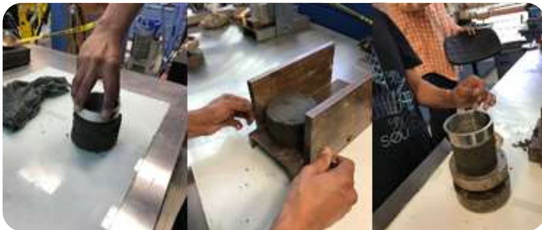
Figura A.2 Anillo para la muestra de la Celda Rowe
