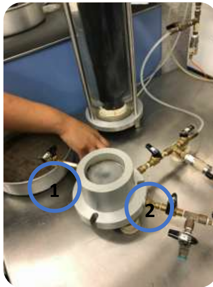
Figura A.5 Cuerpo de la celda junto con la muestra a ensayar
