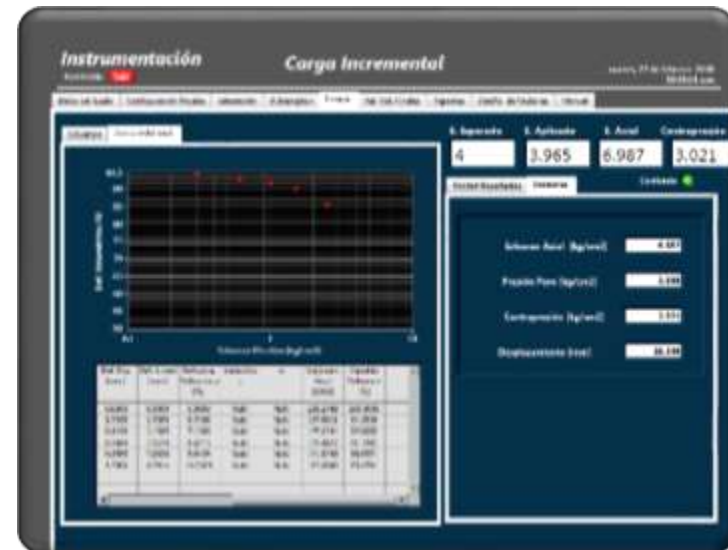
Ilustración B.13 Curva de compresibilidad (Cuando se da la siguiente etapa en la curva de compresibilidad ya se puede ver el registro de la etapa anterior)
