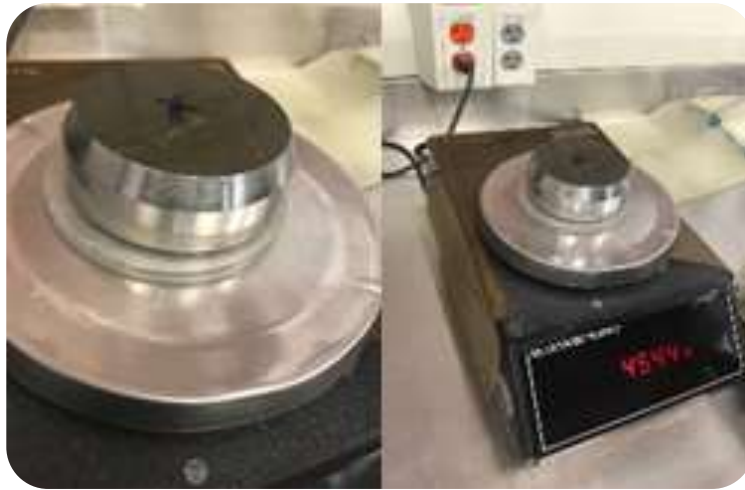
Figura A.3 Anillo de Celda Rowe con muestra.
