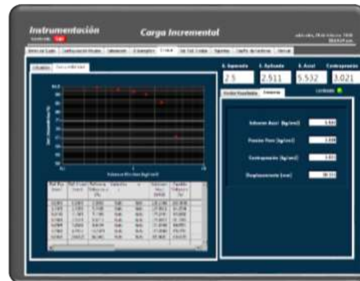
Figura B.15 Curva de compresibilidad (Cuando se da la siguiente etapa en la curva de compresibilidad ya se puede ver el registro de la etapa anterior)
