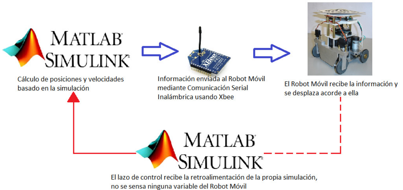
Figura 30. Arquitectura del sistema en Lazo Semi-Cerrado
