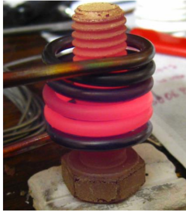
Figura 2.13. El calor radiado por el perno produce que la espira se caliente demasiado y se junte con la espira de abajo, provocando un corto circuito [2.14].
