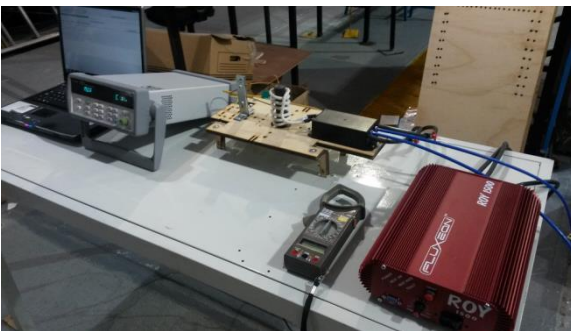
Figuras 4.5 y 4.6. Micro horno de inducción acoplado para la segunda prueba experimental (izquierda) y estructura soporte con la probeta de prueba (derecha).
