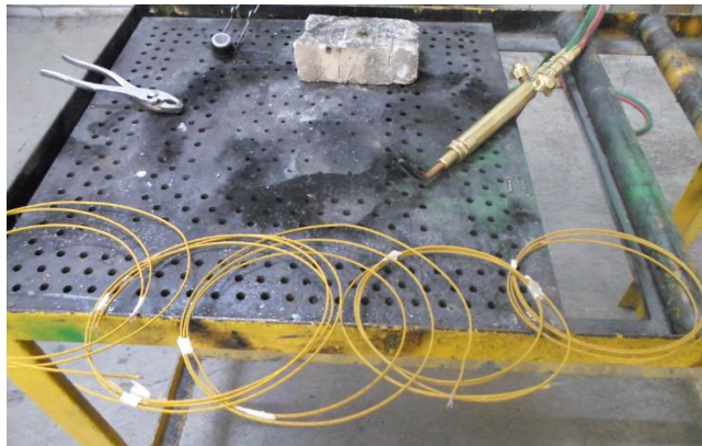
Figura 3.6. Preparación de los cables para termopar tipo K con soldadura de gas argón.
