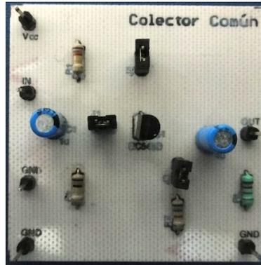
Figura 4.15 Circuito impreso colector común.
