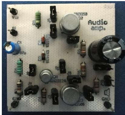
Figura 4.35 Circuito impreso amplificador de audio.
