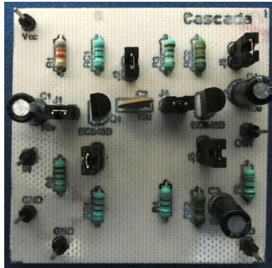
Figura 4.21 Circuito impreso amplificadores en cascada.
