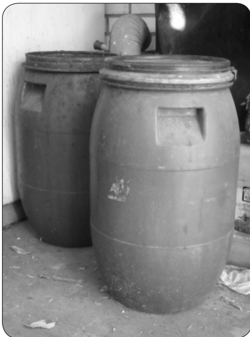
Figura 2.29 Contenedores con cal para controlar pH
