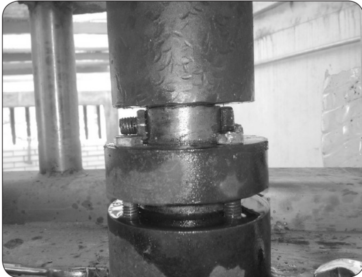
Figura 2.35 Engranés y tuercas del motor del reactor anaerobio R-I después del mantenimiento
