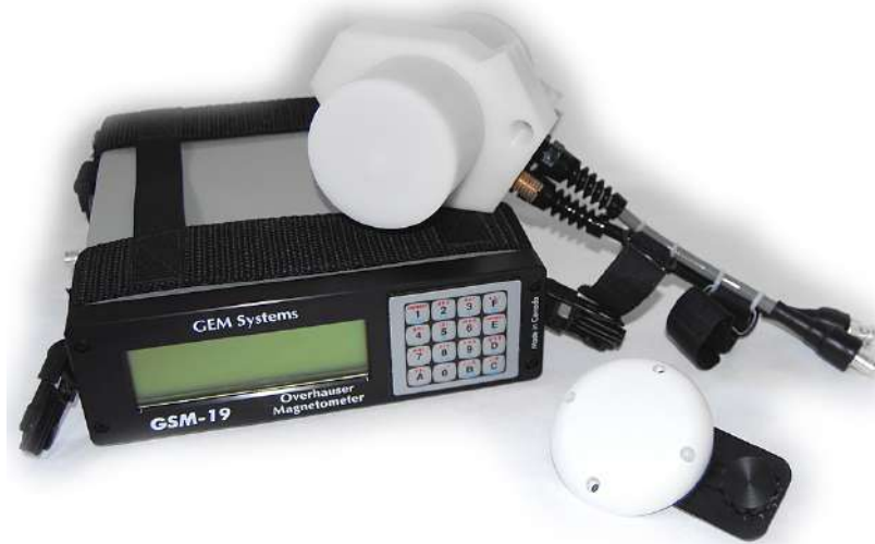
FIGURA 4.3: Magnetómetro GSM-19 Tipo Overhauser. Imagen tomada de: http://www.gemsys.ca/rugged-overhauser-magnetometer/
