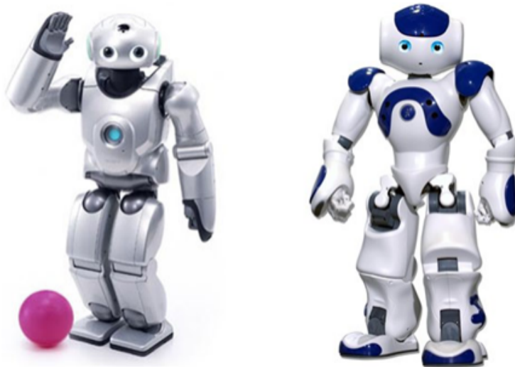
Figura 2.11: A la izquierda, QRIO, un humanoide de entretenimiento que fue cancelado en el 2006. A la derecha, NAO, el reemplazo de AIBO como plataforma estandar en la RoboCup.
