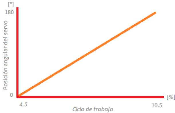
Figura 4.6: Relación ciclo de trabajo - posición angular del servomotor
