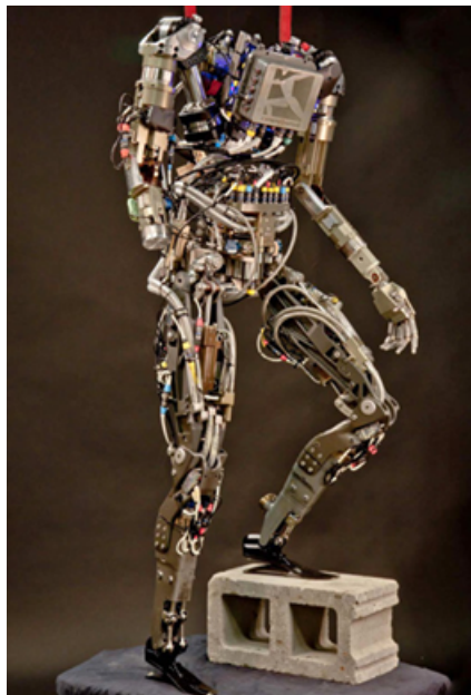
Figura 2.14: Prototipo del bípedo Atlas. Según sus diseñadores, una vez terminado, será capaz de caminar sobre terrenos desiguales.
