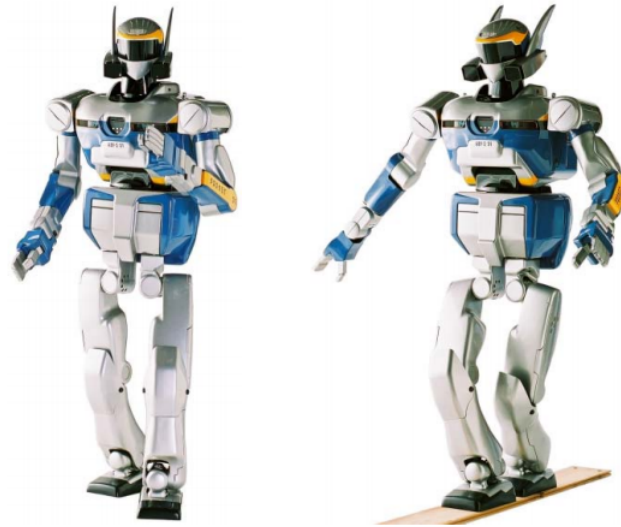
Figura 2.6: El robot humanoide HRP-2. Puede caminar sobre superficies irregulares o sobre caminos estrechos.
