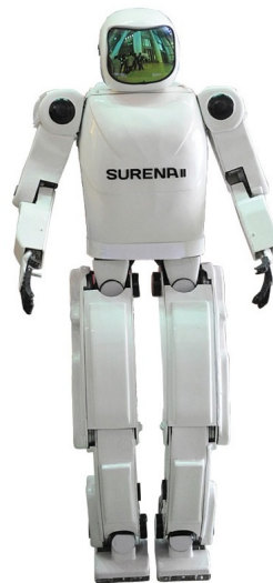
Figura 2.8: Surena II, un humanoide desarrollado con el propósito de explorar aspectos teóricos y prácticos de la caminata bípeda.
