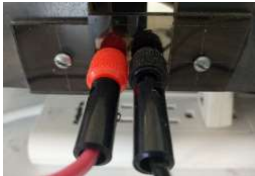
Figura 6-12 Conexión para fuente interna/externa.
