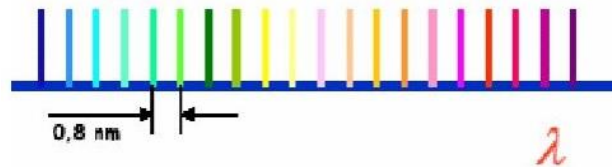
Imagen 12 Multiplexación DWDM: 128 canales con un espaciamiento de 0.8 nm entre ellos (Monografías.com, 2018)
