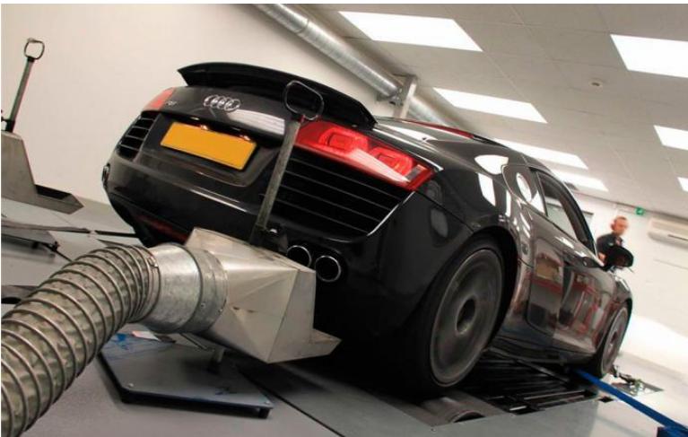
Ilustración 17. Prueba en dinamómetro de chasis.
