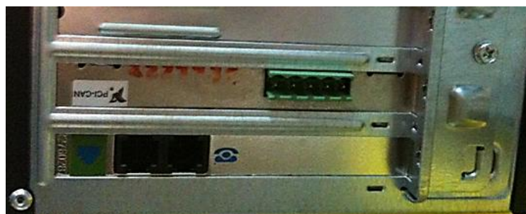
Figura 2.17. Tarjeta NI PCI-DNET instalada en una computadora.
