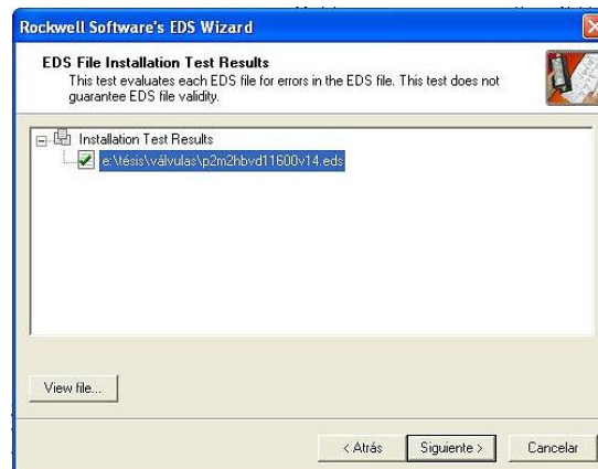
Figura 3.8. Ventana con el EDS instalado.
