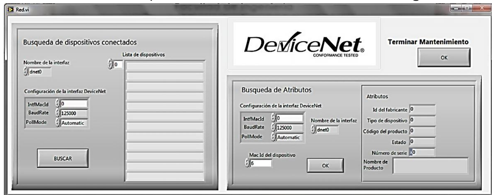
Figura 4.7. Ventana para comprobar el funcionamiento de la red.
