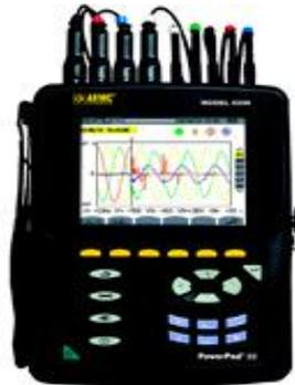
**Figura 4.4** Analizador de calidad de energía (AEMC CA8336).
