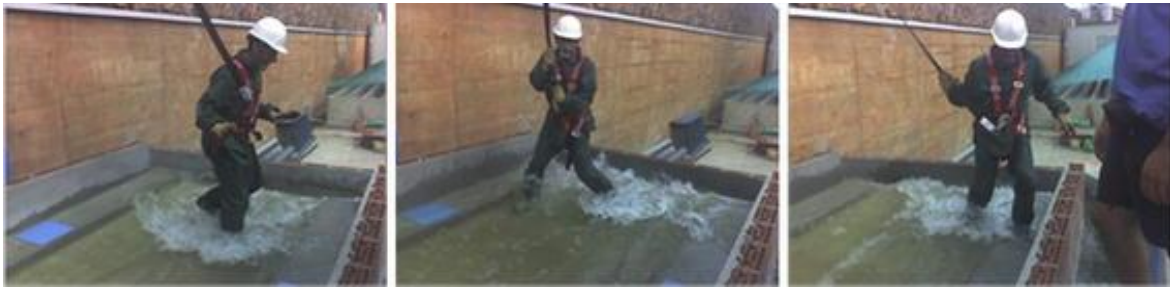
Figura 2-23. Pruebas experimentales en (Russo et al., 2013) de la estabilidad de una persona simulando el cruce de una calle con presencia del flujo de agua. Fuente: (Russo et al., 2013).
