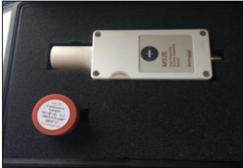
Figura 10 Equipo Barrington y el estándar MS2E utilizado para la medición de susceptibilidad magnética en las muestras de la Cuenca Cieneguilla.
