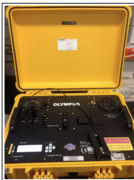
Figura 8 Equipo de DRX utilizado para la identificaron los minerales evaporíticos y clásticos en los sedimentos de la Cuenca Cieneguilla.
