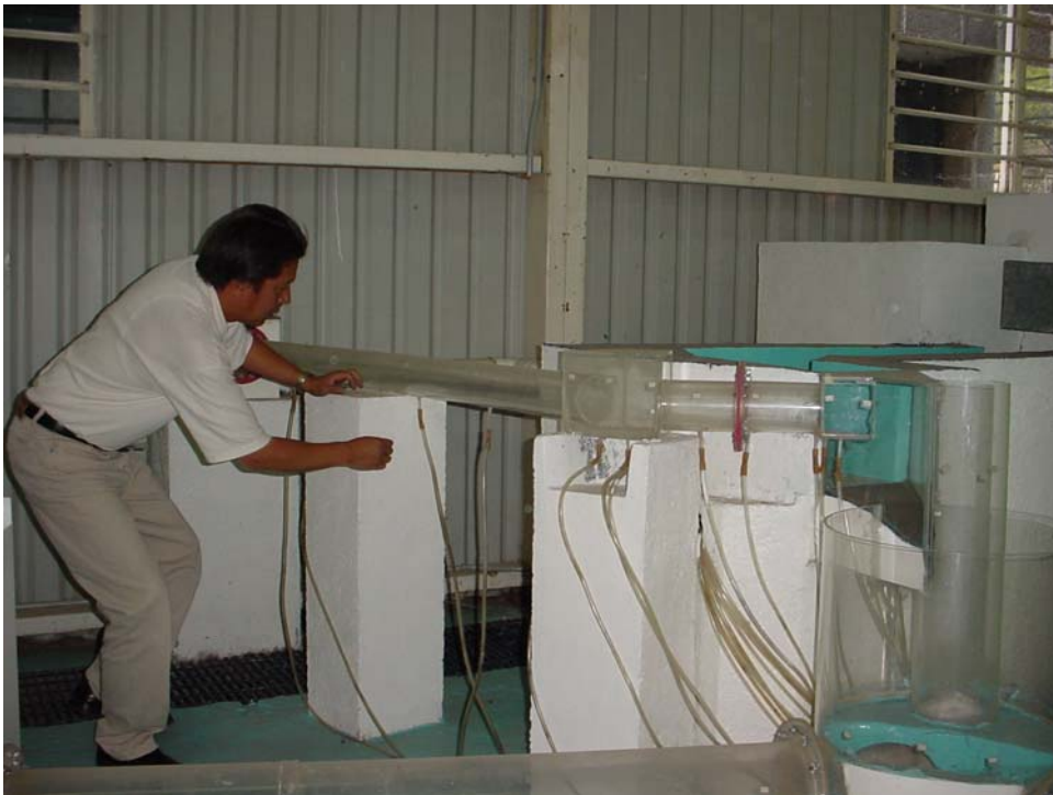
Foto 4. Adecuación del modelo de la captación de la Obra de Toma del Gran Canal a la lumbrera 8 del I.O.
