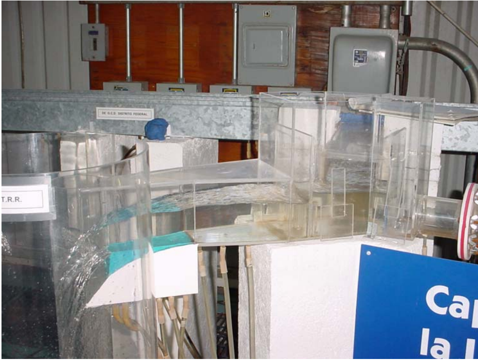
Foto 3. Funcionamiento del modelo de captación de la L2 del TRR modificado.
