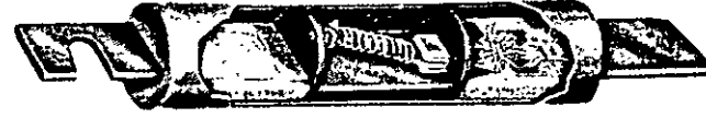
4. Una corriente de corto circuito ocasiona que se fundan las porciones de los elementos de corto circuito con área de sección recta pequeña, haciendo que los arcos quemen los espacios resultantes suprimidos por material absorbente de arcos y por la creciente resistencia del arco.
