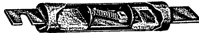
5. Fusible de elemento dual, abierto después de desconectar un corto circuito. (b)
