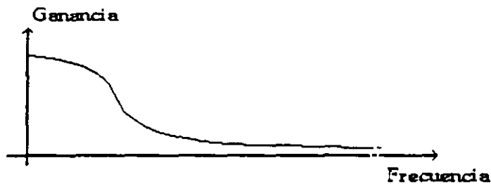
Respuesta a la frecuencia de una línea de transmisión
