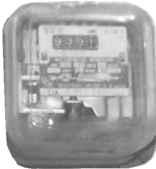
Figura 1.2. Watorimetro o medidor de energía eléctrica.
