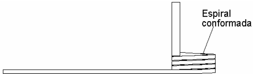
Figura 1.6. Conformado de la espiral.
