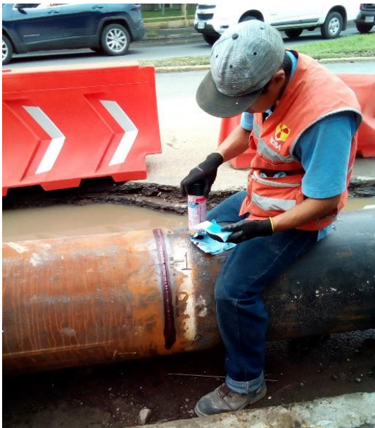
Imágenes 40 y 41, inspección de soldadura en juntas de la tubería de acero, por el método o de radiografía y líquidos penetrantes.
