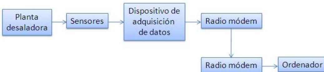
Figura 24. Diagrama a bloques del sistema de instrumentación y telemetría.
