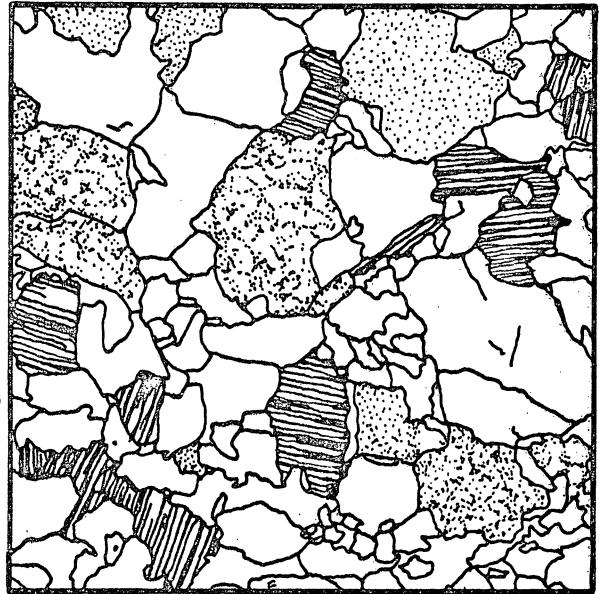
Fig. IV-23 (c). Estructura granuda de tipo normal (X-25) Granite común. La plagioclasa (con resto de la albíta) es subautomorfa, mientras que la microclina cuadrada es totalmente xenomorfa. El cuarzo, en blanco rellena los intersticios. Se aprecia escasa mica en la lámina delgada.
