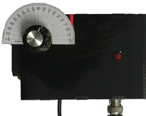
Figura 26. Equipo de detección de fase con medidor de ángulo.
