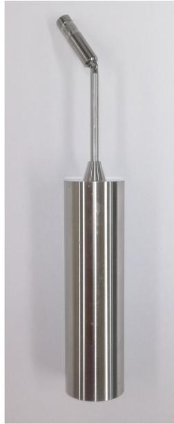
**Figura 3.6:** Fotografía de aguja del adaptador UL Brookfield
