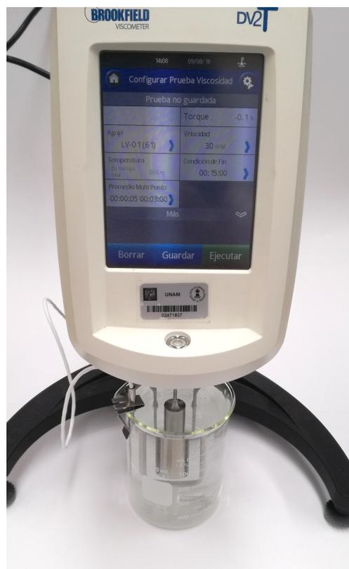
**Figura 3.5:** Fotografía del viscosímetro Brookfield DV2T
