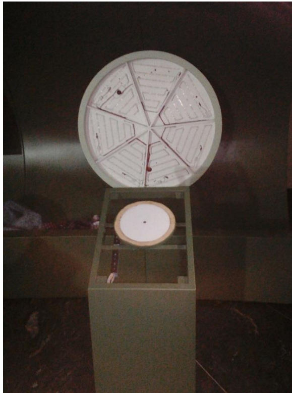
Figura 7 Exhibición de sensores touch. En la parte superior se encuentra una circunferencia con tiras led para iluminar la sección de imagen correspondiente, y en la parte inferior el atril con los sensores touch y la electrónica.
