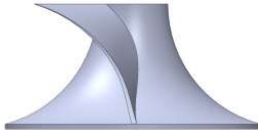
Figura 6. 5 Perfil de álabe de rotor erróneo
