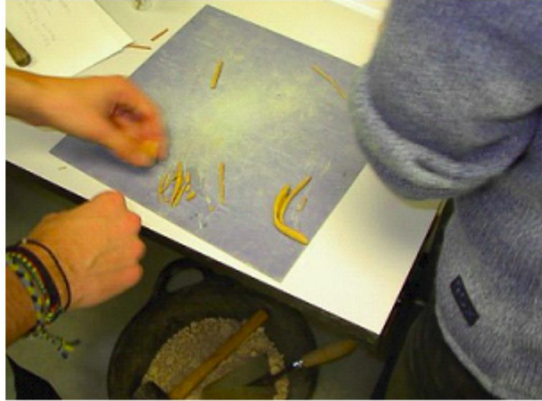
Figura 2.8 Determinación del Límite Plástico (tomada de Holtz & Kovacs, 1981)
