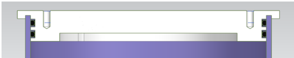
Figura 3.10 Vista en corte de la tapa de Nylamid con los alojamientos (blanca), el tubo de policarbonato y el par de sellos o-ring.
