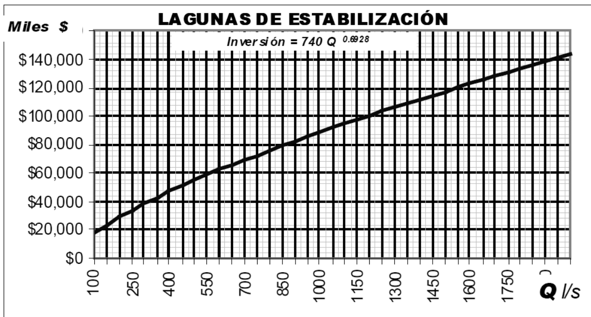
Figura 1-9. Costo de inversión para lagunas de estabilización en función del gasto a tratar. Fuente: Mantilla Morales G. [et al.]. (2002). Costos índice de sistemas de tratamiento de aguas residuales en México. Instituto Mexicano de Tecnología del Agua.
