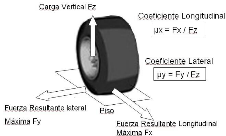
Figura 2.17 Coeficiente de fricción en un neumático. [12]
